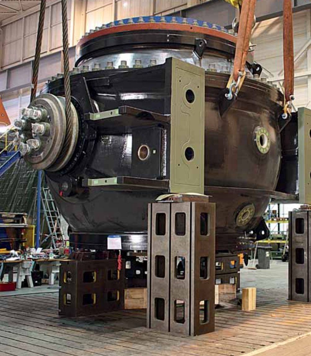
▲ Válvula esférica para la CH Herdecke durante su ensamble en taller
