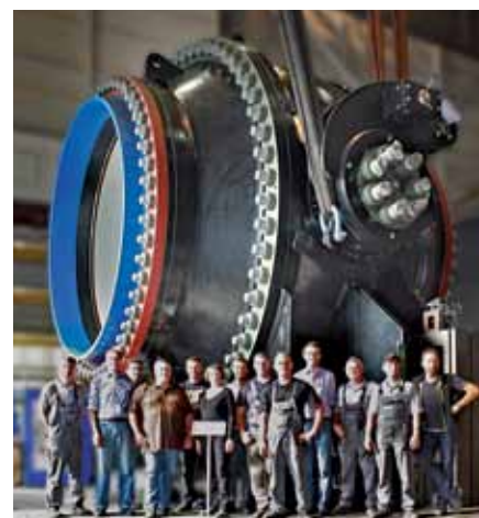
▲ Válvula esférica para la CH Herdecke: fin de prueba de estanquidad, después de la renovación
